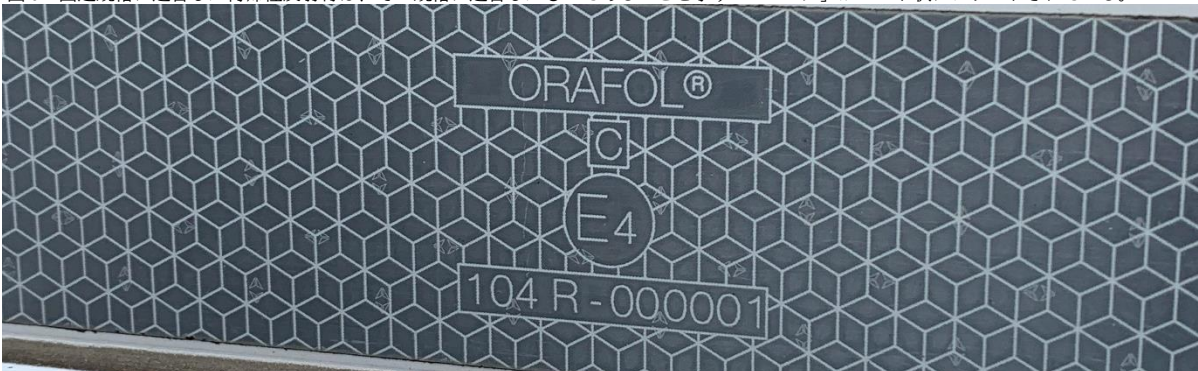
図7 ただし、斜め方向からの入射では、プリズム式反射材の特性上、反射効果が半減する場合があります
